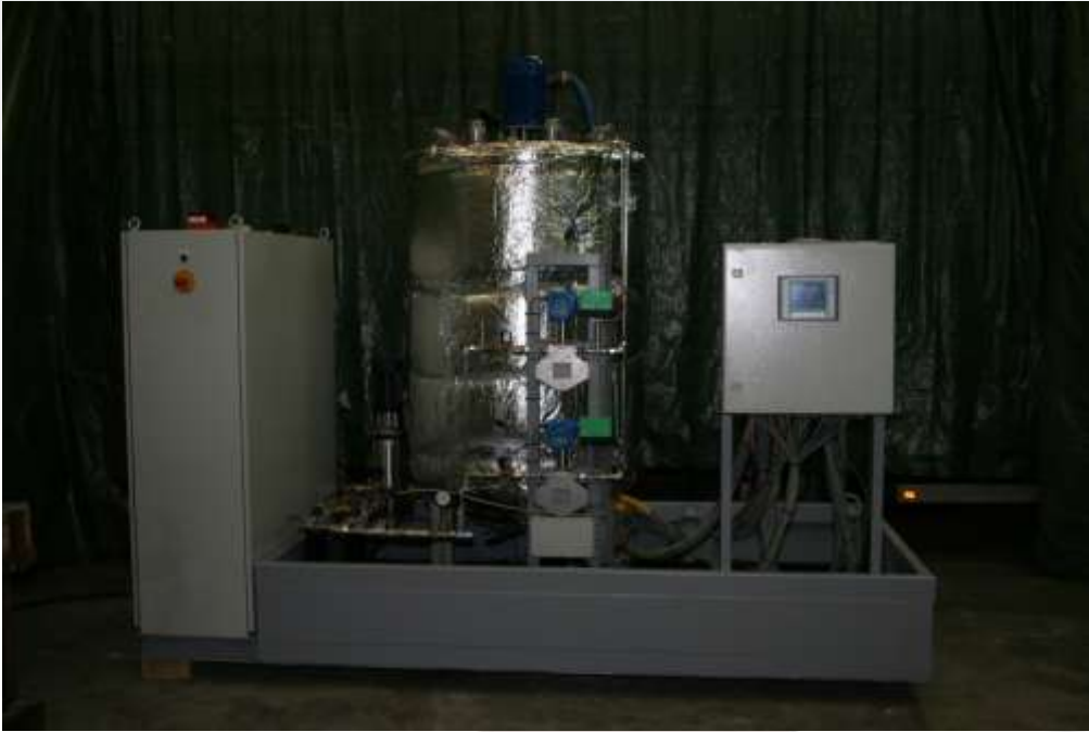
Automatisoitu PLC-ohjattu lämmitys- / annosteluyksikkö teollisuuden käyttöön.
