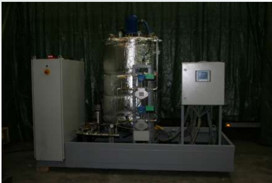
Automatiserad PLC-styrd uppvärmnings- / doseringsenhet för industriellt bruk.
