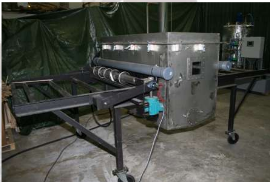
Behandlings- / ångbox monterad på transportlinje för industriellt bruk.
